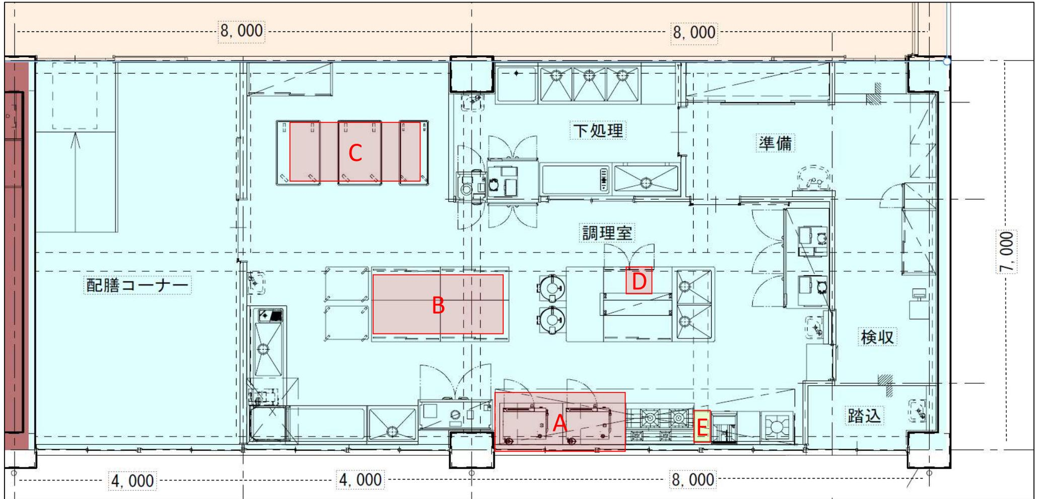
A: ブラストチラー    B: 計量器    C: 真空包装機    D: ミキサー
